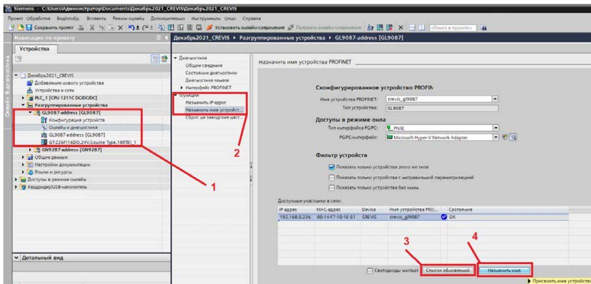
Назначение IP-адреса сетевому адаптеру CREVIS GL-9087 производится непосредственно контроллером (указанный в проекте IP-адрес) по PROFINET имени адаптера. Запись IP-адреса с помощью TIA PORTAL не поддерживается.
