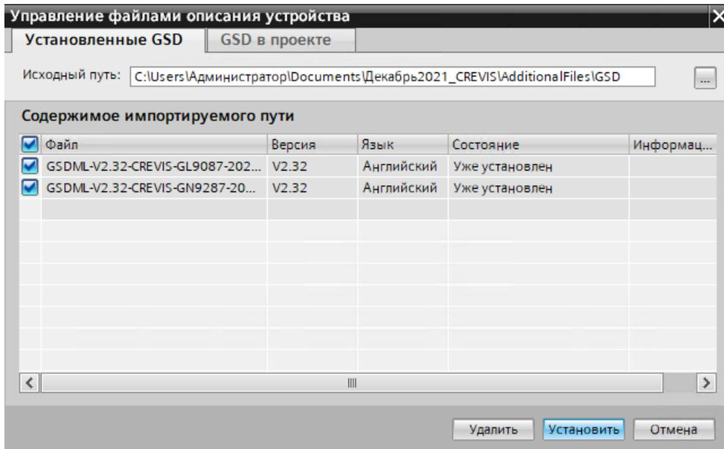
Для добавления адаптера к существующей PROFINET сети необходимо перейти в меню «Просмотр сетевых соединений», в правой части экрана в каталоге найти нужный модуль CREVIS и методом Drag-And-Drop перетащить адаптер в основное окно.
