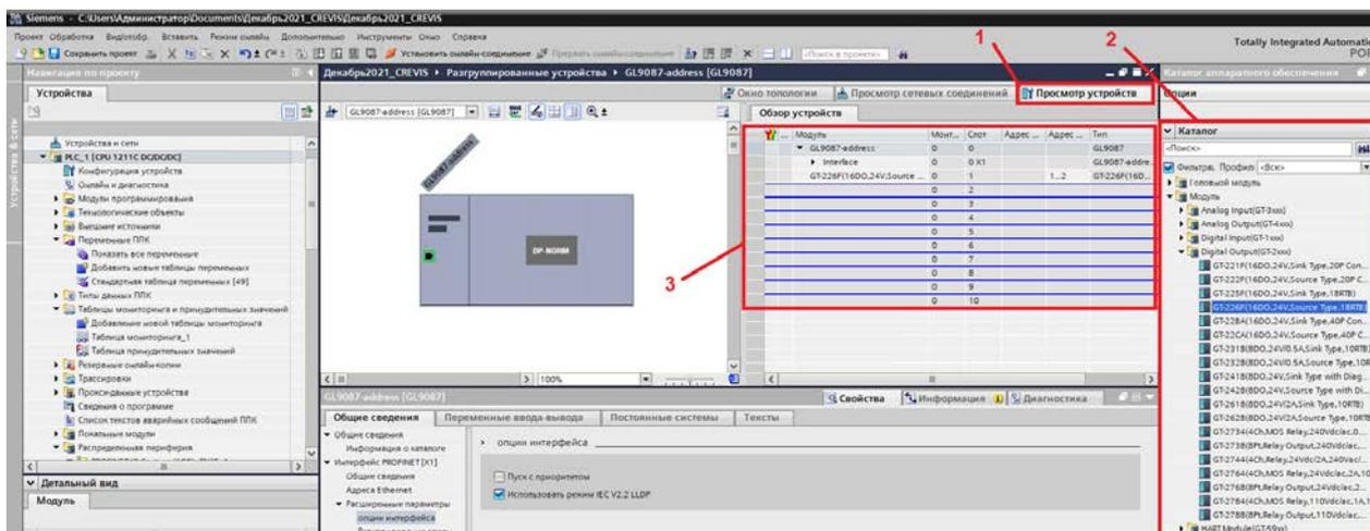
Назначить PROFINET имя адаптеру CREVIS можно в меню «GN9087-address» (имя устройства в проекте) - «Онлайн и диагностика» в соответствующей вкладке.
