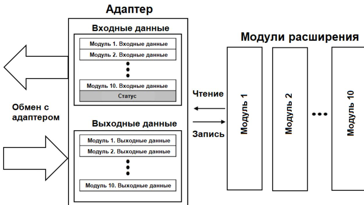
Общая таблица отображения в адаптере автоматически присваивается входным адресам (I address) и выходным адресам (Q address) по порядку следования модулей в корзине адаптера. После конфигурирования корзины адаптера в меню «Device View» эти адреса можно установить вручную.
